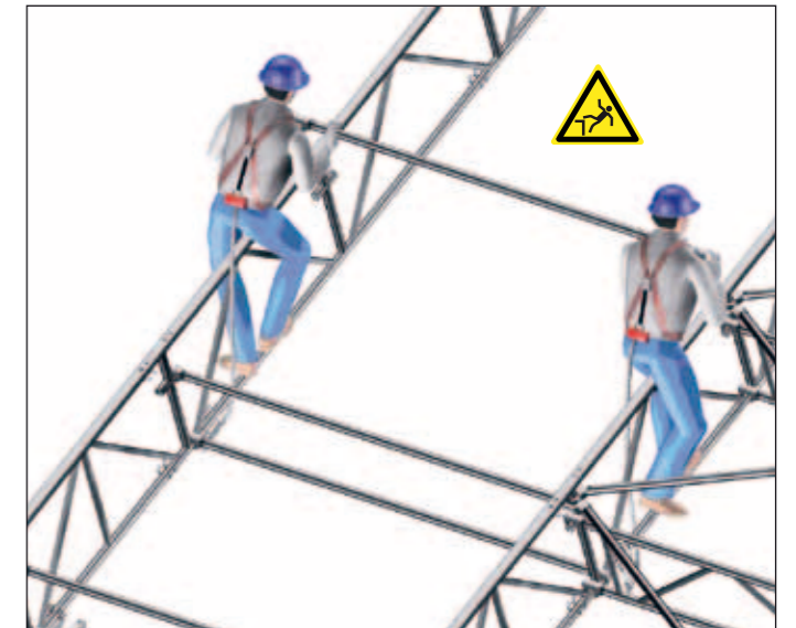
Kuva 1: Asentamisessa on aina käytettävä turvalajaita.
